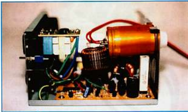
Fig.4: Prototype met filter en extra belastingsweerstand
